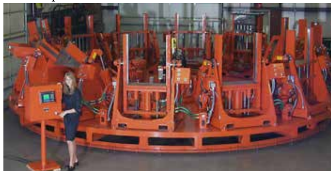
HALL 12 Estación Giratoria con Equipos de Colado RT2 (Sin los moldes instalados)
