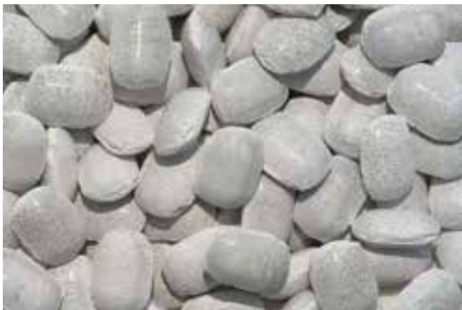
Figura 5: Ilustración del fundente base a óxido de sodio Na-BF para horno eléctrico y con vertido a presión.
