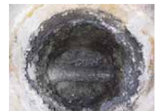
Figura 12a y 12b – Cuchara Tundish de 1 Ton luego del tratamiento con NaBF
