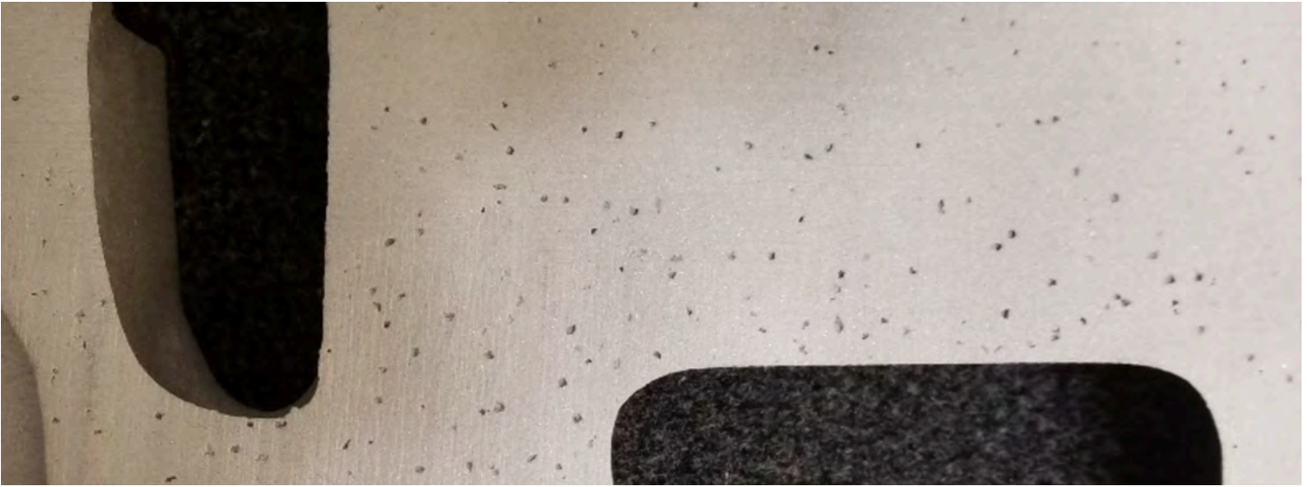
Esta pieza exhibe "Porosidad por Hidrógeno". Su causa es completamente diferente de los otros 5 tipos de porosidad. Comprender las diferencias es la clave para solucionar el problema
