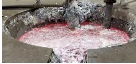
Los óxidos adheridos a las paredes de este horno de fusión contribuirán a la tasa de scrap.
