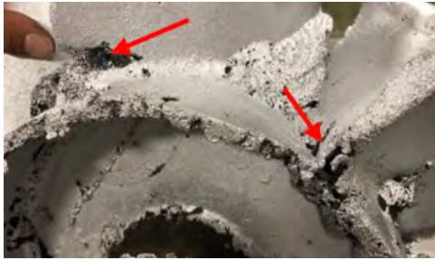
Restos de arena y escoria deben quitarse de las piezas scrap antes de colocarlas en el horno.
