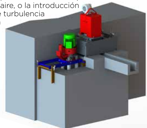
Sistema de Transferencia Launder MMEI Filtrada con Desgasificador Rotatorio
